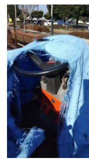
(劣化したブルーシート)
